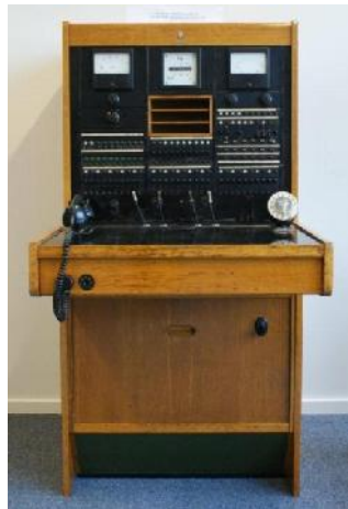
Foto: handcentraalpost van een telefooncentrale
